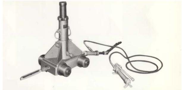
※手動式ポンプによる車両脱線復旧ジャッキ
