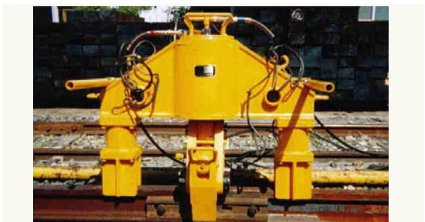
※レール継目落整正器
