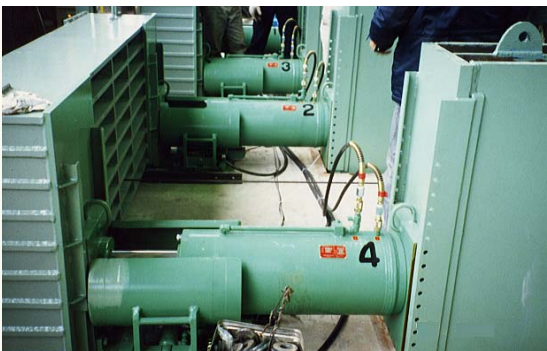
※100t×500mm センターホールジャッキ PC鋼線緊張装置
