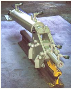
※重量物移動ジャッキ 30×300ストローク
