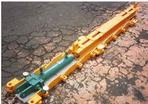
※重量物横移動装置 橋梁桁横取(200t用)
